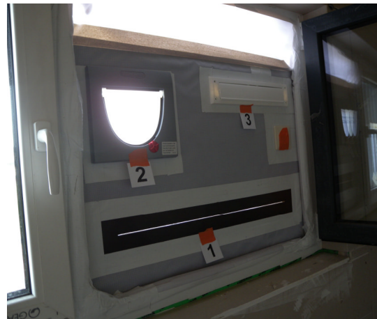
Abbildung 4: Künstlich geschaffene Lecks. Kellertürschwelle (1), Katzenklappe (2), Briefkastenschlitz (3).
